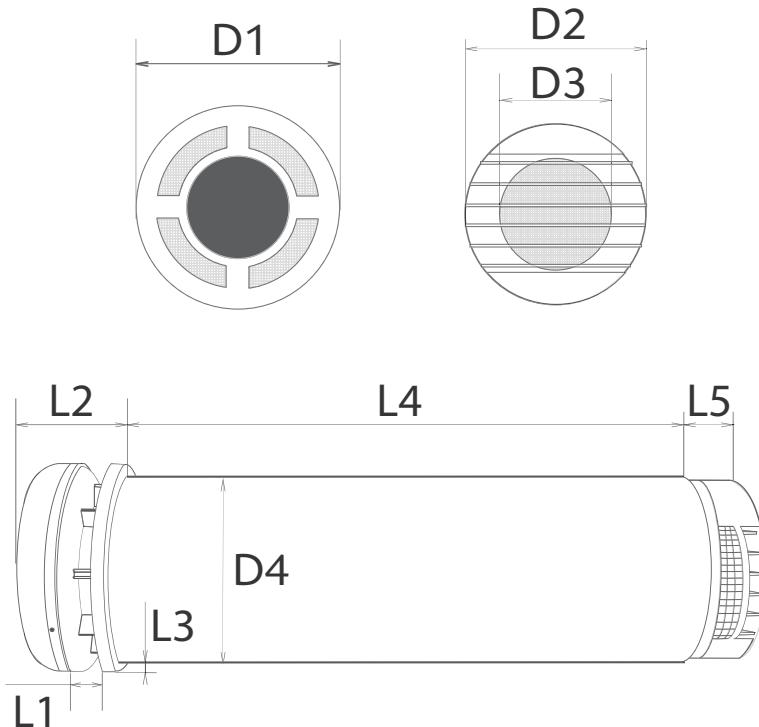
Системи з довжиною робочого модулю L4 до 1000 мм виготовляються у вигляді моноблоку.
